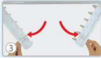
3. ซันตัวล็อกตรงกลาง แล้วดึงชุดใบปรับลมตั้งออกจากลูกกรงซ้าย-ขวา
