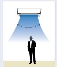
ระบบกระจายลมแบบอัตโนมัติ (Auto Swing) ซ้าย-ขวา สั่งงานผ่านรีโมทคอนโทรล
