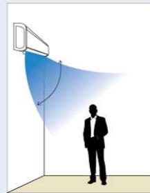
ระบบกระจายลมแบบอัตโนมัติ (Auto Swing) ขึ้น-ลง สั่งงานผ่านรีโมทคอนโทรล
