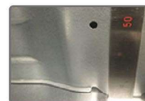
ลดขนาดช่องช่องที่จะเข้าถึงแผงวงจรลงให้น้อยกว่า 4 มม.
